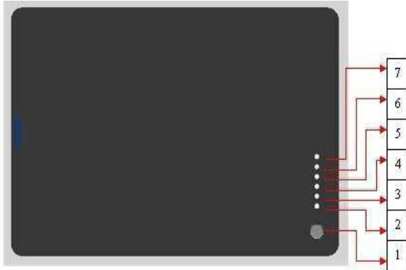
Una vez encendida la centralita con la tarjeta SIM instalada, tras 30 segundos el sistema se encontrará en modo normal de funcionamiento, con el led 7 encendido y el led 3 parpadeando cada 2 segundos.
