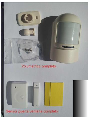
Tanto el volumétrico como el sensor puerta/ventana vienen enlazados con la centralita. Para colocar sensores adicionales consultar el manual (punto 10).
